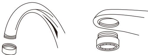
El diámetro del extremo frontal del grifo no es 24/23/22mm El diámetro del extremo frontal del grifo no es 12/18/20/22/28mm
